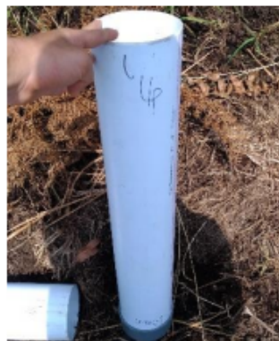
Fig. (Gambar) 1. A-60 cm PVS used to collect peat samples ( Paralon setinggi 60 cm yang digunakan untuk mengambil sampel gambut )
