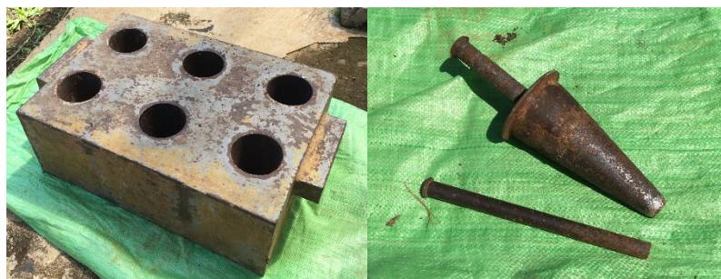
Gambar (Figure) 1. Cetakan logam untuk membuat pot organik ( Metal molds for organic-based pot )
